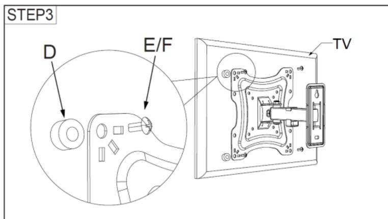
Instale el monitor / TV en la placa frontal con los tornillos adecuados seleccionados de la bolsa de piezas.
