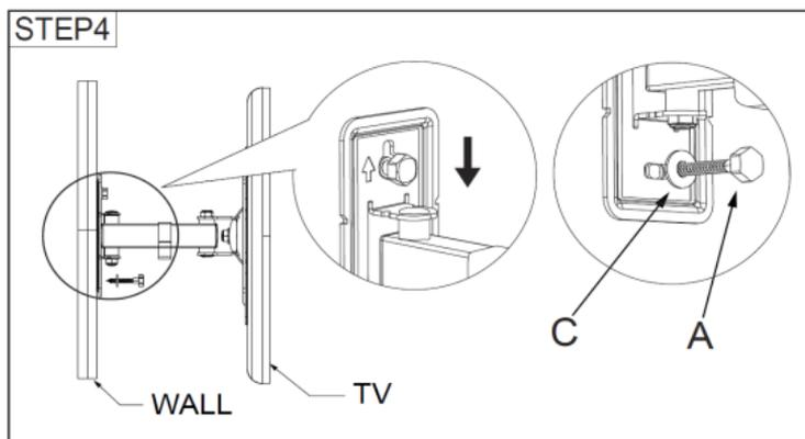
Instale la placa de pared. Coloque la placa de pared sobre los tornillos autorroscantes y mueva la placa de pared hacia abajo. Coloque el tornillo autorroscante en el segundo orificio, ajuste el nivel y ajuste.
