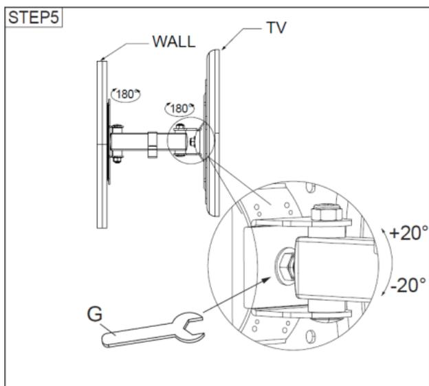
Afloje el tornillo para ajustar el ángulo del monitor / TV 20 ° hacia arriba y hacia abajo.
