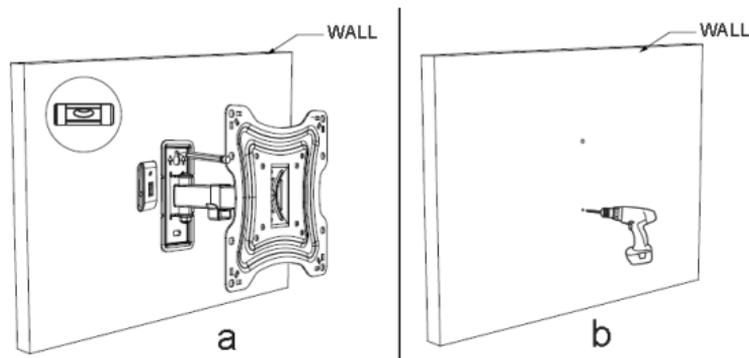
a. Emplee la placa de pared como modelo para dibujar 3 orificios.
