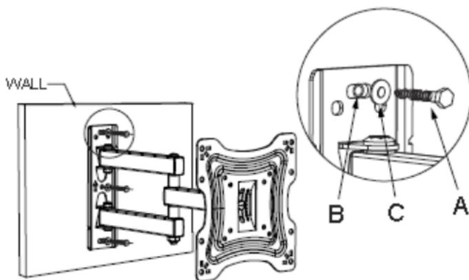
Instale la placa de pared. Coloque la placa de pared en la pared, y luego atornille tres torni-
