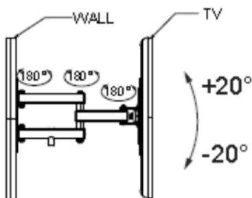
Afloje el tornillo para ajustar el ángulo del monitor / TV 20 ° hacia arriba y hacia abajo, luego apriete el tornillo firmemente.
