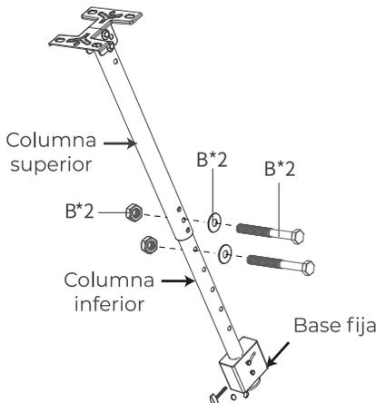
Instale el panel de la pieza de ajuste, cuélguelo del brazo y fíjelo con tornillos a través del ajustador.
